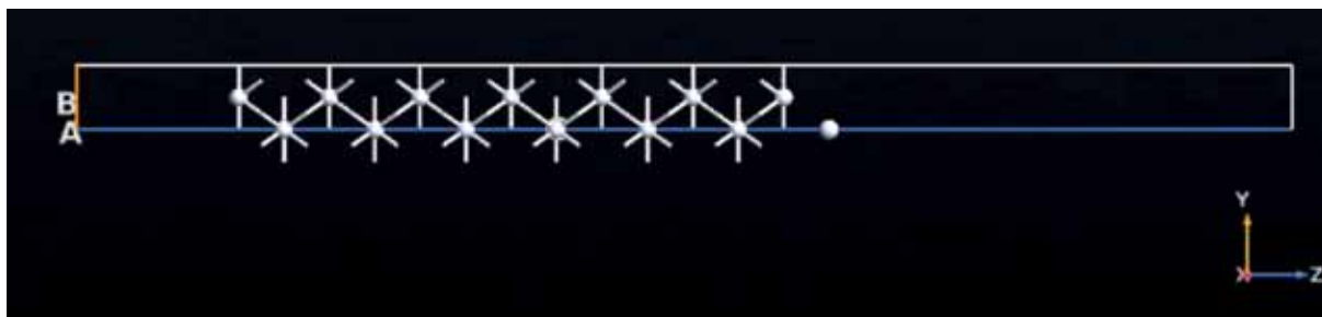
Рисунок 4 — Первопринципная модель автоэмиссионной структуры «металл-вакуум», предназначенная для расчёта работы выхода.
