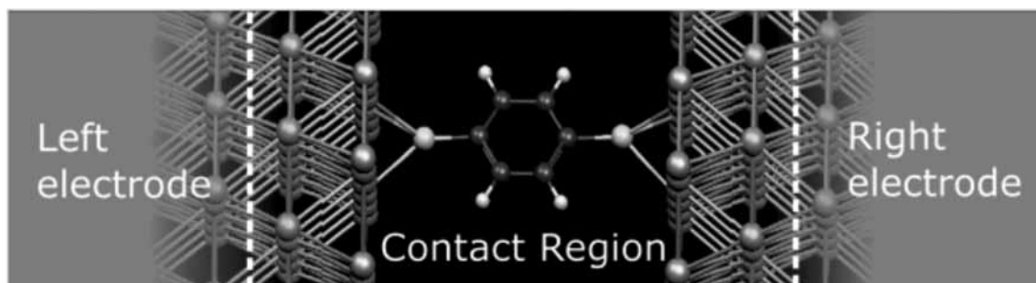
Рисунок 1 — Молекула (бензольное кольцо), помещенная между полубесконечными электродами из золота [18].
