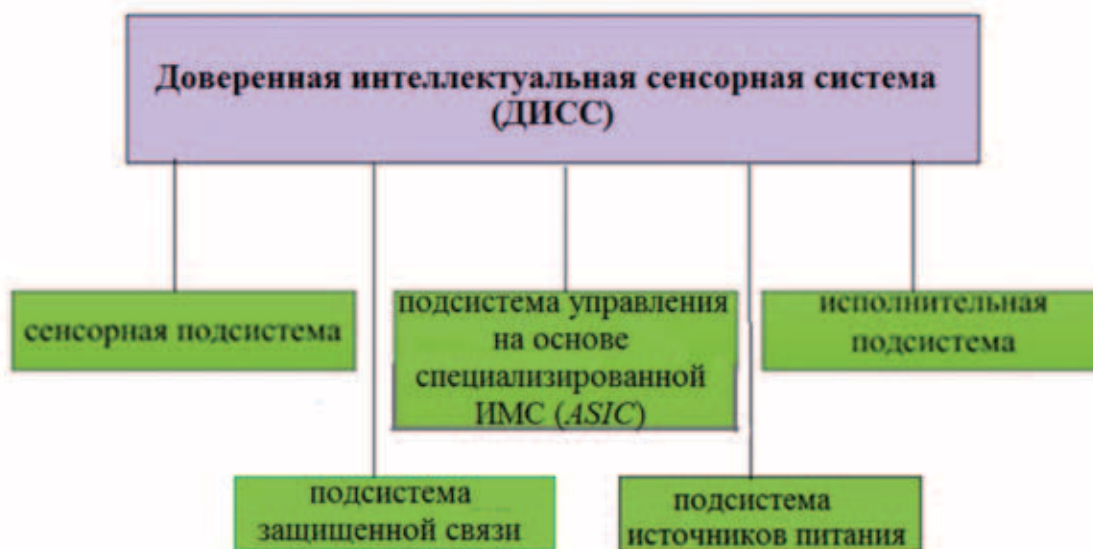
Рис. 5. Состав и структура доверенной интеллектуальной сенсорной системы: сенсорная подсистема (набор датчиков одинаковых или различных физических величин); подсистема управления на основе специализированной микросхемы с опцией искусственного интеллекта (возможности обучения); исполнительная подсистема на основе МЭМС-механизмов; подсистема защищенной беспроводной связи; подсистема источников питания.
