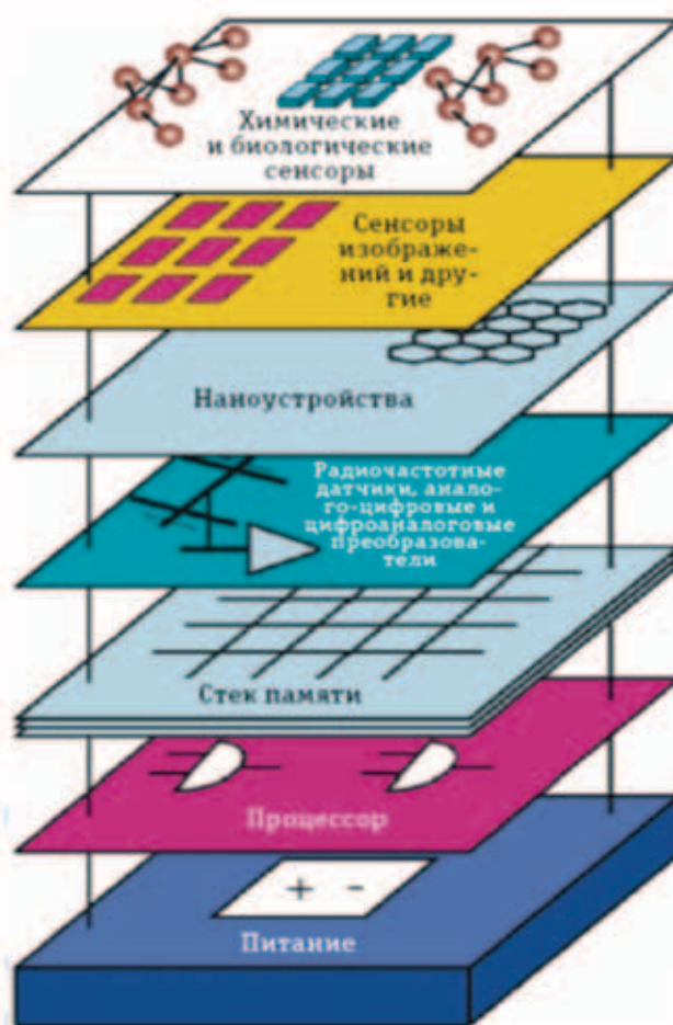
Рис. 12. Блок-схема компьютера для систем окружающего и искусственного интеллекта, а также доверенных интеллектуальных сенсорных систем (ДИСС) [31].
