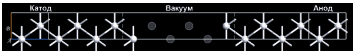
Рисунок 3 — Двухэлектродная система Pt-вакуум-Pt, представленная в виде цепочки атомов Pt, разделенных вакуумным зазором.
